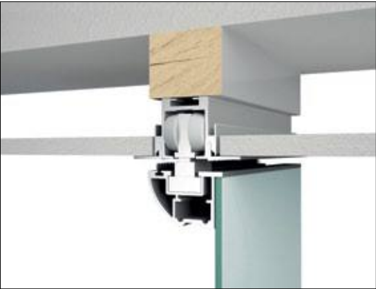
Travi di scorrimento ad incasso a soffitto a 2 vie Two way ceiling built-in sliding rail
